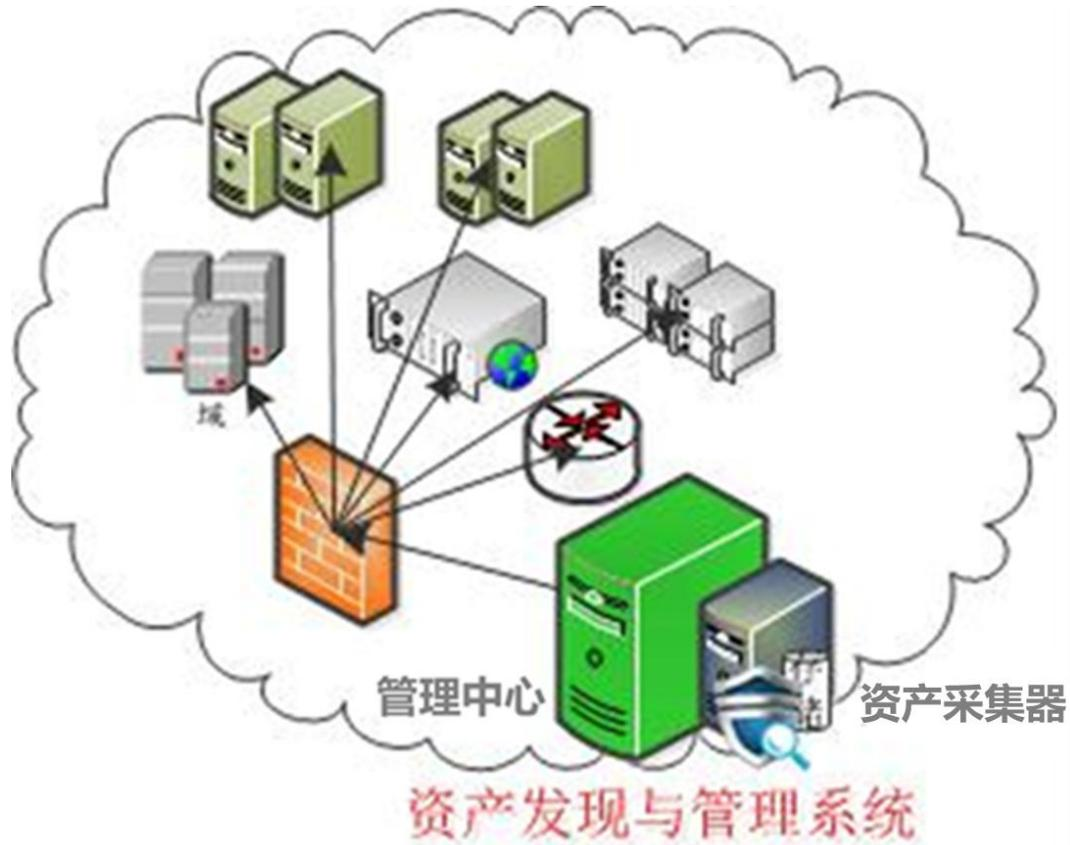
单级部署模式又叫路由或网桥部署模式，该部署模式对客户网络的要求比较简单，只要系统的管理中心以及资产扫描器（AC）与管理对象之间网络可达即可。对于网络拓扑结构简单，规模较小以及安全级别相同的客户网络来说，通过产品的简单部署即可实现，即在服务器上部署管理中心并架设一台资产扫描器（AC），管理中心就可以正常工作，实现对全网的资产发现和管理。对于网络拓扑结构复杂、物理位置分散、安全级别有差异的网络，建议采用单级的分布式部署方式，即在中心服务器部署管理中心，在其他多个网络位置部署多台分资产扫描器。如上图所示，显示了系统的一个单级分布式部署场景。
