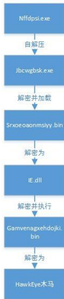
图 2.11 嵌套木马的解密执行流程
